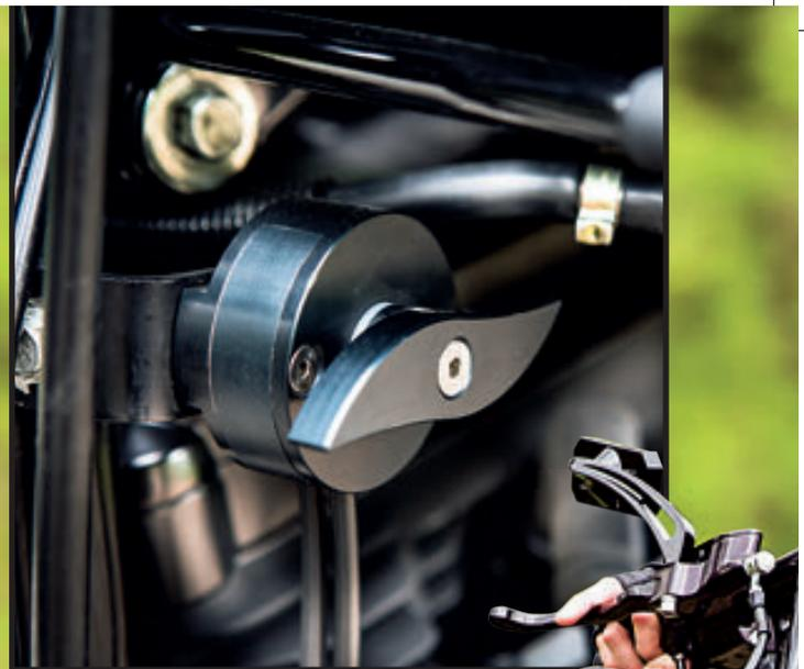
Der Drehregler öffnet die Penzl-Auspuffanlage
