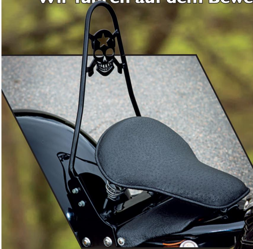
Schwingsattel und Sissybar bilden eine Einheit und wurden im Haus von Big V-Twin hergestellt
